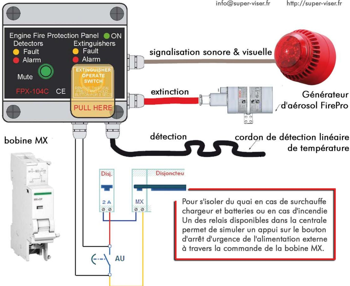
Système de protection contre l'incendie répondant aux exigences du chapitre II SOLAS. La centrale FPX104C détecte l'incendie et permet de commander manuellement l'extinction. Elle contrôle jusqu'à 4 générateurs FirePro, entièrement supervisée même pour la décharge.
